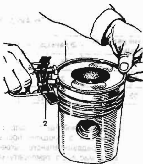
Рис. 13. Установка колец на поршень с помощью приспособления
